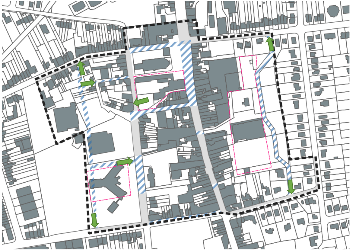
Accès automobile au réseau routier existant (flèches vertes) selon la carte d'affectation de la ZEC et le rapport l'accompagnant (en zone hachurée et grises les zones accessibles aux voitures dans la carte d'affectation de la ZEC, et en rose les zones de parking souterrain).
