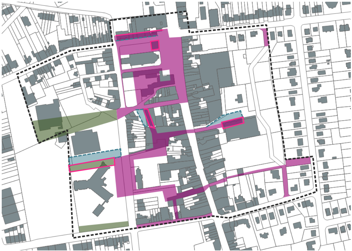
Zones non-bâtissables proposées par la ZEC et variante liée au dessin des zones pour limiter les démolitions et leur impact (en rouge les zones/éléments problématiques et en bleu les propositions)
